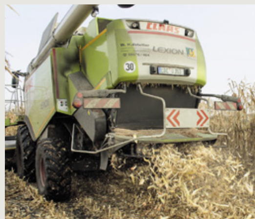
Der BioChipper von BioG aus Österreich ist ein umgebauter Mulcher, der das Stroh seitlich (links) als Schwad ablegt.
