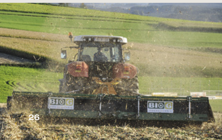
Der BioChipper von BioG aus Österreich ist ein umgebauter Mulcher, der das Stroh seitlich (links) als Schwad ablegt.
